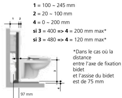
\*Dans le cas où la distance entre l'axe de fixation bidet et l'assise du bidet est de 75 mm
