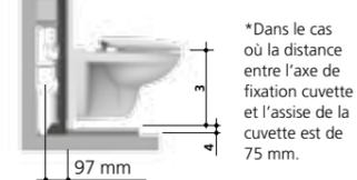
\*Dans le cas où la distance entre l'axe de fixation cuvette et l'assise de la cuvette est de 75 mm.
