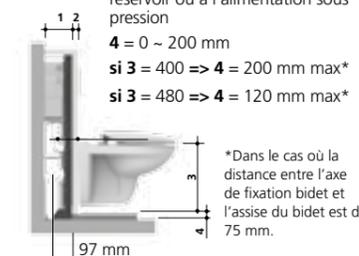
\*Dans le cas où la distance entre l'axe de fixation bidet et l'assise du bidet est de 75 mm.
