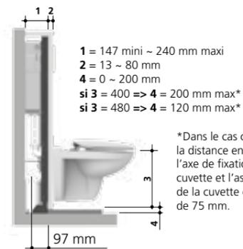
\*Dans le cas où la distance entre l'axe de fixation cuvette et l'assise de la cuvette est de 75 mm.
